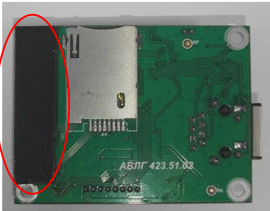
Рисунок 2. Место крепления двустороннего скотча к БФПИ
