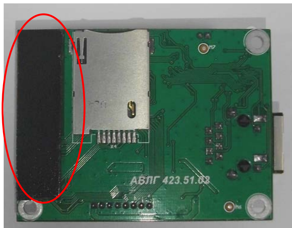
Рисунок 2. Место крепления двустороннего скотча к БФПИ
