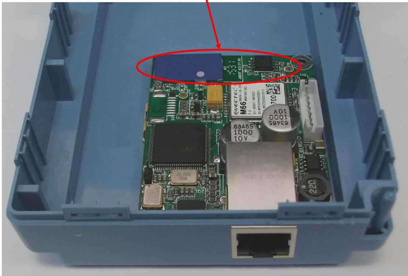
Рисунок 3. БФПИ, установленный в ККМ
